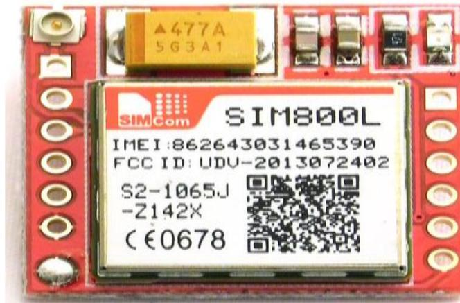
Fig. 7. SIM800L GSM/GPRS modem
