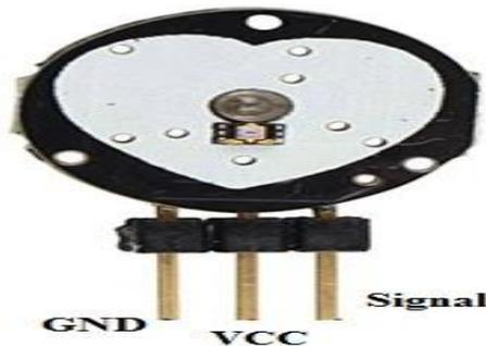
Fig. 9. Pulse sensor
